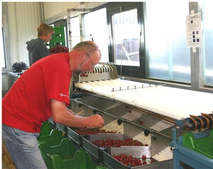
Abb. 1: Größensortierung bei Süßkirschen mit der Sortieranlage 'Select'
