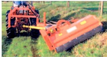
**Schlegelmulchgerät Typ „HSHN“ mit hydraulischer Seitenverschiebung und hydraulischer Neigungsverstellung**
